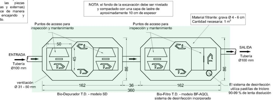
NOTA: el fondo de la excavación debe ser nivelado y compactado con una capa de lastre de aproximadamente 10 cm de espesor
