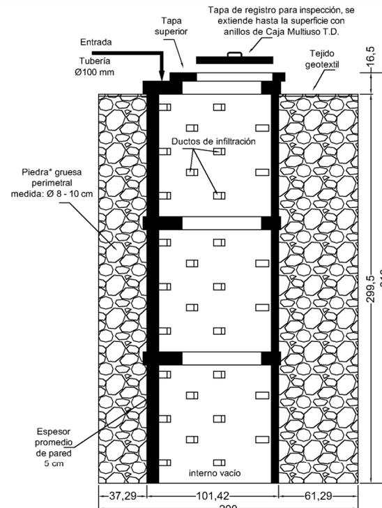
Pozo Absorbente Prefabricado T.D. Modelo PAP-9 con piedra perimetral sección vertical - medidas en cm
