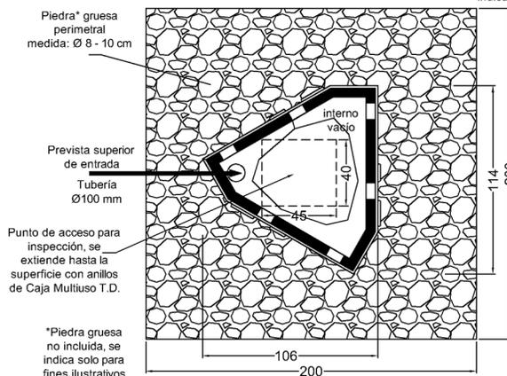
Pozo Absorbente Prefabricado T.D. Modelo PAP-9 con piedra perimetral sección horizontal - medidas en cm
