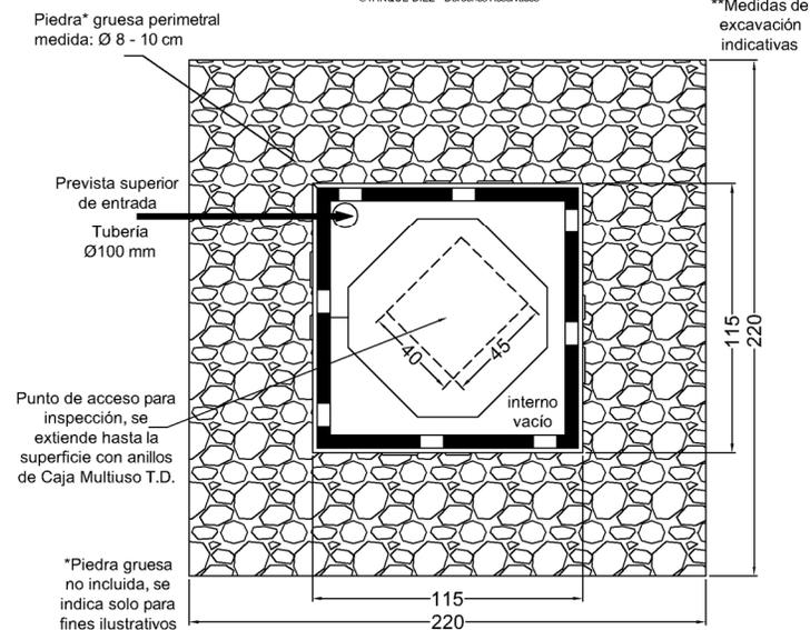
Pozo Absorbente Prefabricado T.D. Modelo PAP-8 con piedra perimetral sección horizontal - medidas en cm
