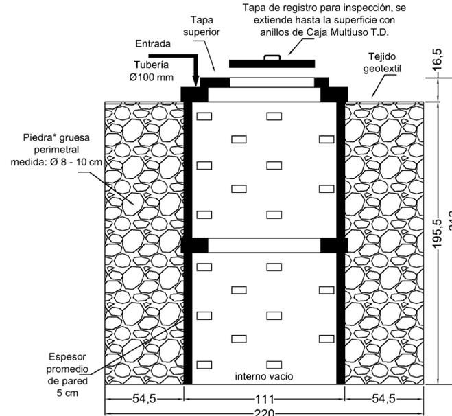
Pozo Absorbente Prefabricado T.D. Modelo PAP-8 con piedra perimetral sección vertical - medidas en cm
