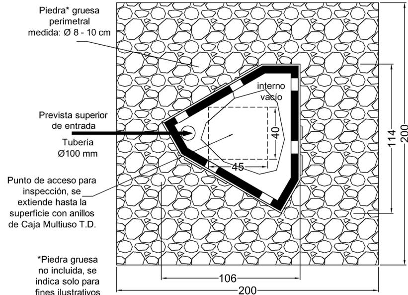
Pozo Absorbente Prefabricado T.D.
