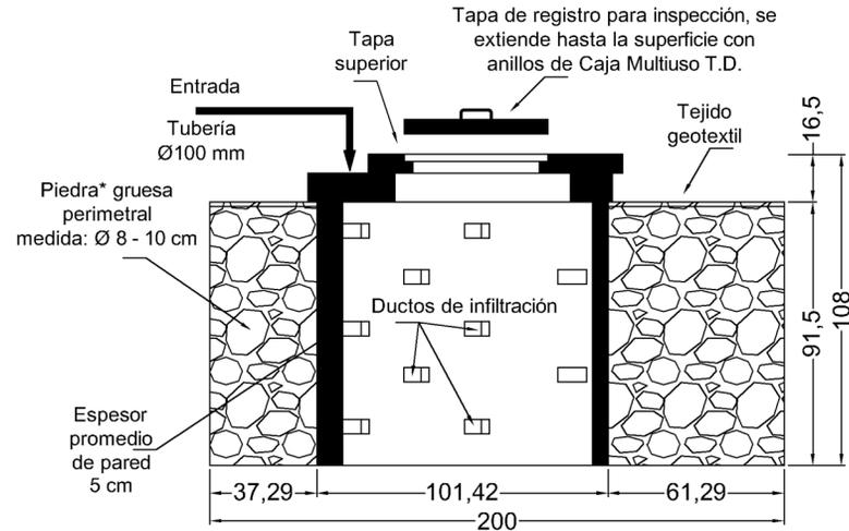
Pozo Absorbente Prefabricado T.D.
